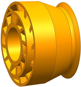
图2 双级轴向旋流器 Fig.2 Dual-stage axial swirler
